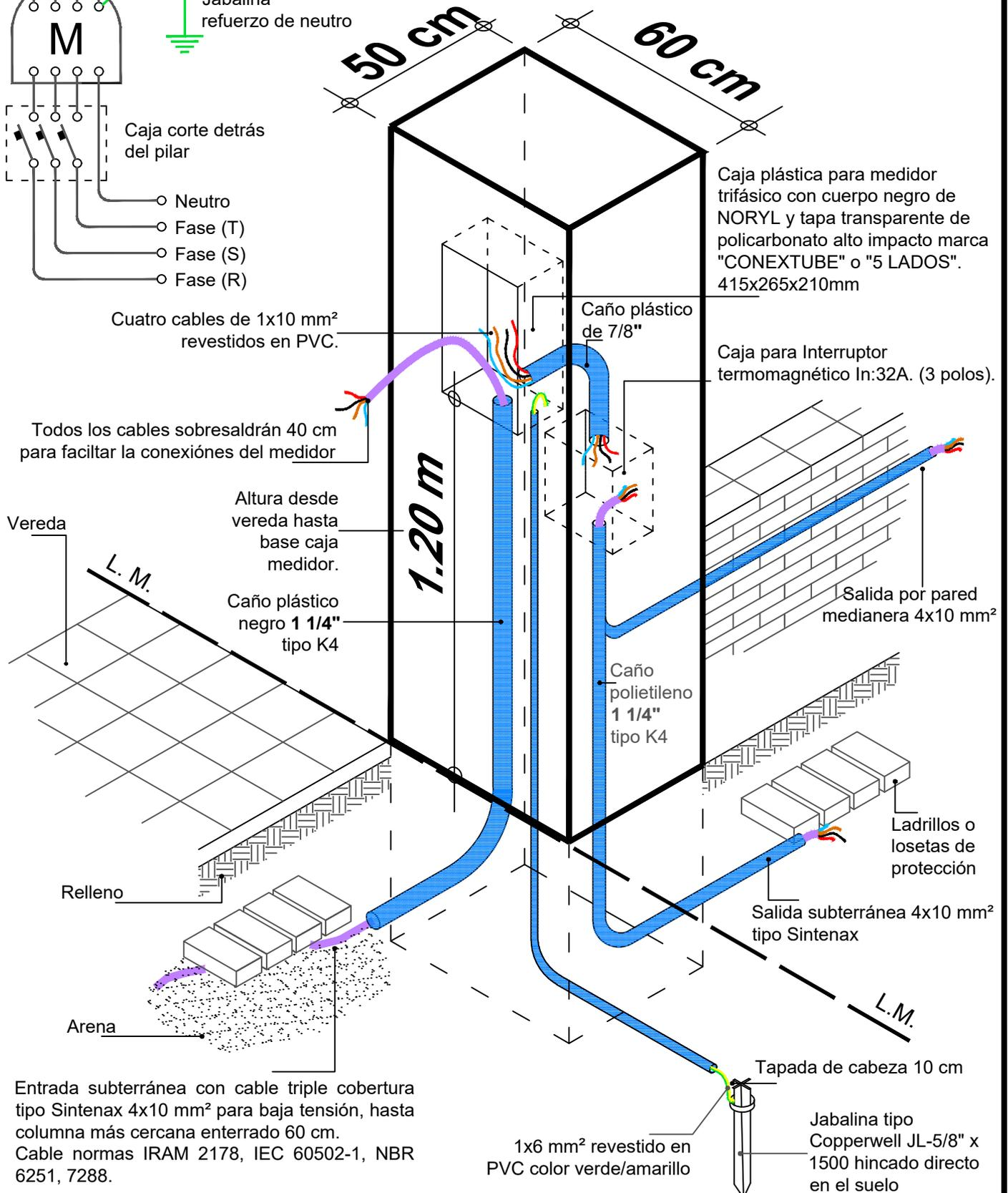
Entrada subterránea con cable triple cobertura tipo Sintenax 4x10 mm<sup>2</sup> para baja tensión, hasta columna más cercana enterrado 60 cm. Cable normas IRAM 2178, IEC 60502-1, NBR 6251, 7288.
